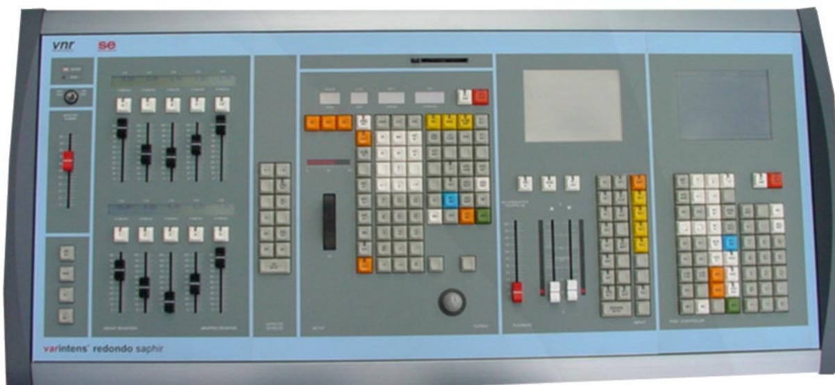
Cette régie se compose d'une série de platines de commande interconnectées par un bus Arcnet (Tokenring). Cette solution permet de proposer un produit extensible se composant d'au maximum 255 sous ensembles.
